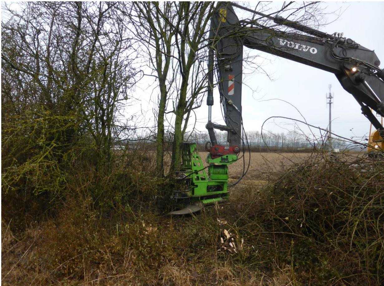
*Maschinelle Heckenpflege mit Bagger und Zwickzange*
