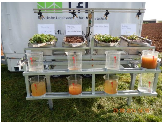
Der Regensimulator zeigt die Folgen starker Niederschläge auf unterschiedliche Bodenoberflächen
